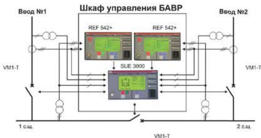
Рисунок 2 – Функциональная схема устройства БАВР УБАВР-В изготавливается на базе:
