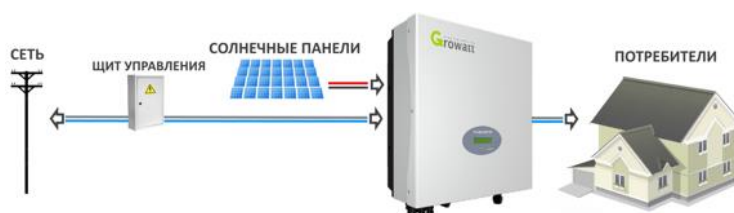
Рисунок 1 – Принцип работы сетевой солнечной электростанции
