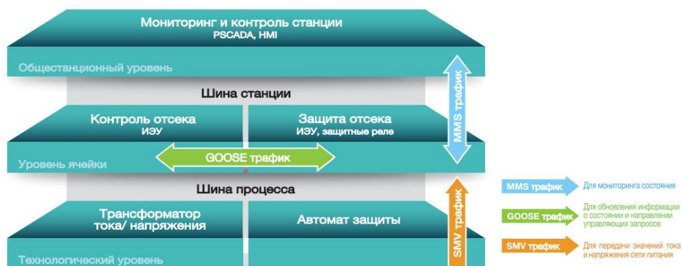
Рисунок 2 – Коммуникационная архитектура подстанции по стандарту МЭК 61850
