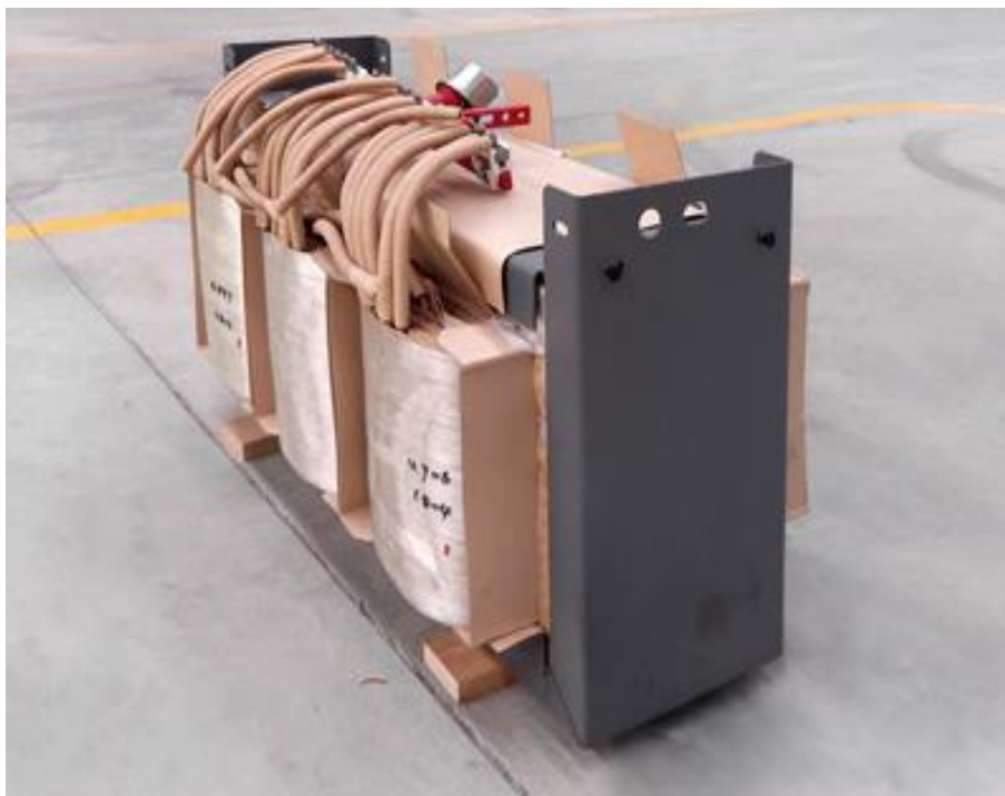
Рисунок 2 - Активная часть трансформатора из аморфной стали
