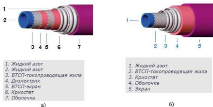
Рисунок 2 - Конструкция высокотемпературного сверхпроводникового кабеля: а) с холодным диэлектриком; б) с теплым диэлектриком [1]
