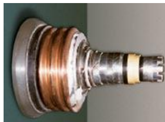
Рисунок 1 - низкотемпературный сверхпроводниковый силовой кабель на 3 ГВА [2]
