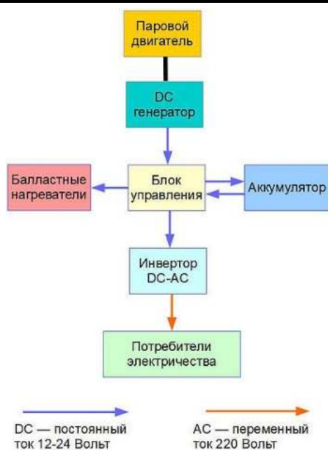
Рисунок 1 – Принципиальная схема генерации и преобразования электрической энергии [2]
