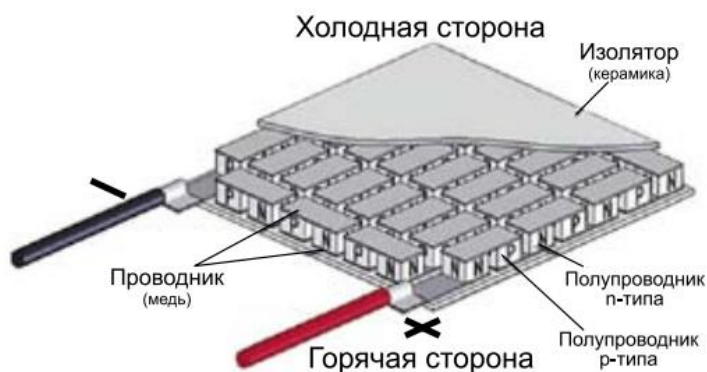
Рисунок 2 – Конструкция ТЭМ
