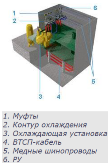
Рисунок 3 - Схематичный разрез подстанции АМК, Копенгаген[1]
