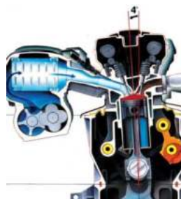
Рисунок 1 – Двигатель внутреннего сгорания Saab Variable Compression с регулированием степени сжатия изменением положения блока цилиндров [4]
