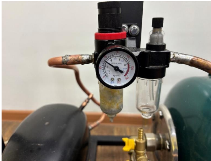
Рисунок 5 – Припаянная медная трубка к фильтру
