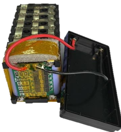
Рисунок 3 – Готовая АБ состоящая из двадцати одной ячейки Li-ion аккумулятора и устройства BMS на 40A
