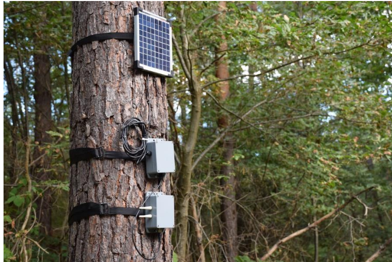
Рисунок 3 – Стационарный датчик и солнечная батарея, установленные на дереве в рамках локального мониторинга
