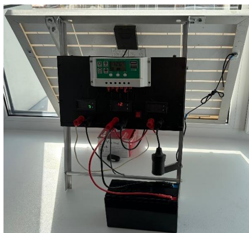
Рисунок 4 – Готовый переносной лабораторный стенд с подключенным Li-ion АБ
