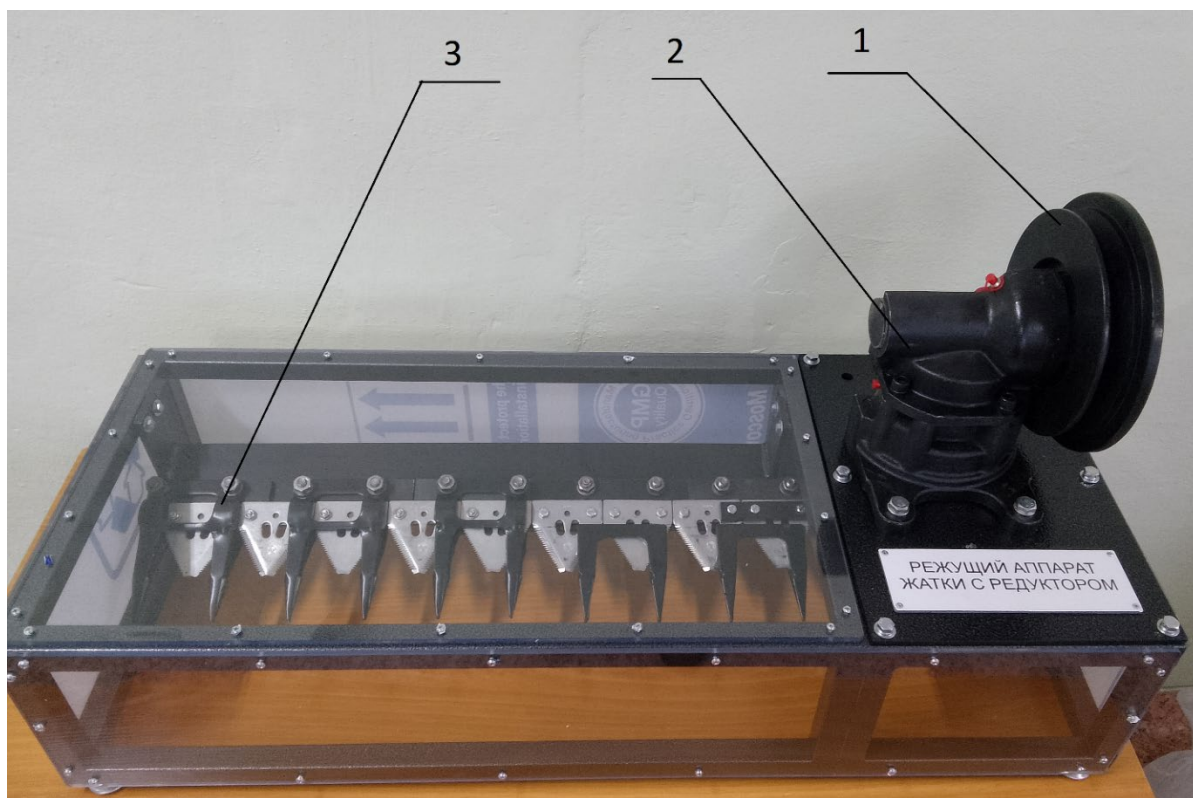
Рисунок 3.1 – Стенд-планшет «Режущий аппарат жатки с редуктором»: 1– шкив; 2– редуктор; 3– режущий аппарат
