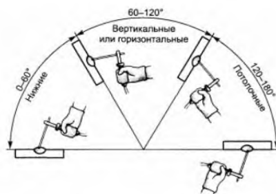
Рисунок 1.12 - Классификация сварных швов по их положению в пространстве
